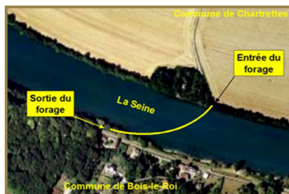
Forage dirigé : Passage sous la Seine
